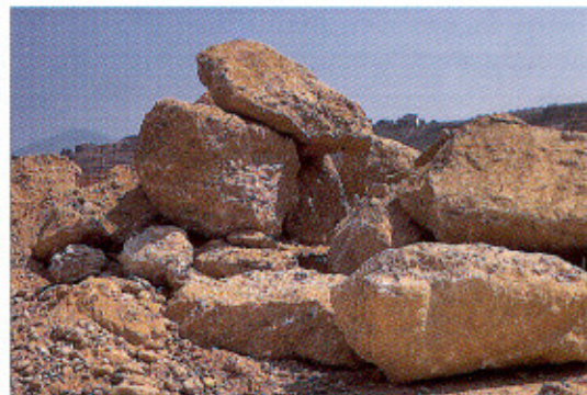
Roche siliceuse (poudingue) de la classe R 42 .
