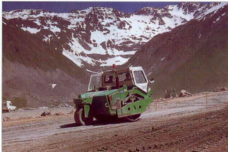
Un compacteur vibrant tandem-transversal de la classe V5 : une morphologie originale permettant une excellente maniabilité et une mobilisation optimale des masses pour le compactage.
