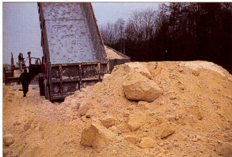
Un sous-produit industriel : le phosphogypse (classe F_5 ). Ce matériau se présente sous l'aspect d'un sable très frottant mais légèrement soluble.
