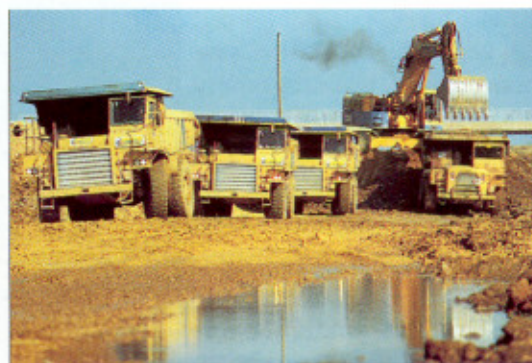
L'extraction frontale (ou en butte), avec un atelier pelle - tombereaux.
